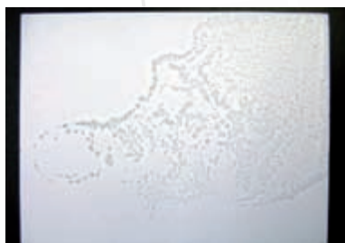
LABS-Test einer silikonöhlhaltigen Probe
