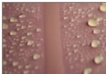
Pics: Kunststoffoberfläche mit PlasmaBeam behandelt und mit Wasser benetzt.
