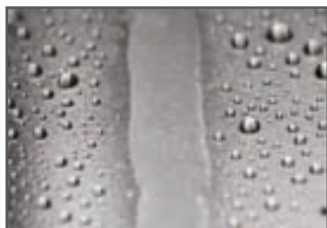
Pics: Aluminiumoberfläche mit PlasmaBeam behandelt und mit Wasser benetzt.
